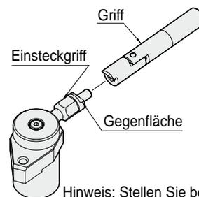
Hinweis: Stellen Sie bei der Montage des Adapters sicher, dass die Gegenfläche waagrecht steht.
