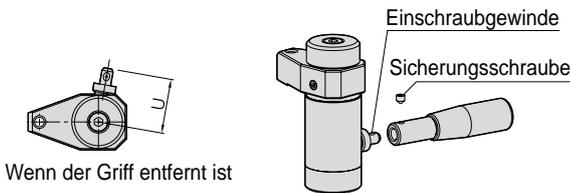
Der Griff kann durch Lösen der Sicherungsschraube entfernt werden. Bei dauerhaft montiertem Griff sicherstellen, dass die Sicherungsschraube vollständig angezogen ist. 3 Griffmontagepositionen
