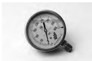
**Manometer zur Drucküberwachung**
