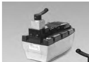
**Pneumohydraulische Pumpe mit Handventil**
